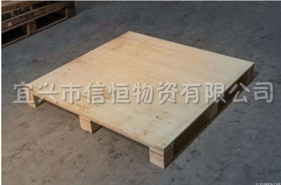
仓库木托盘是托盘中\*\*传统和\*\*普及的类型。主要有两种：纵梁式托盘（两面进叉型）和垫块式托盘（四面进叉型），纵梁式仓库木托盘是北美地区通用的标准型托盘,故又称”美式托盘”。特点是结构简单、生产便捷、整体牢固性好。缺点是基本为双向进叉，在纵梁开”V”型槽口的情况下可实现四向进叉，但也\*\*\*于非手动叉车，更适用于自动化程度较高的搬运条件。垫块式仓库木托盘是欧洲通用的标准型托盘,又称为“欧式托盘”。特点是全部四向进叉，使用方便。缺点是结构复杂，整体牢固性稍差。目前在我国使用较多
